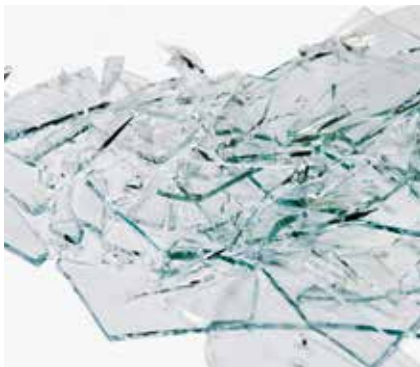
Gewöhnliches Fensterglas zersplittert und der Weg durch das Fenster ist frei.
