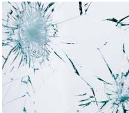
Das Verbundsicherheitsglas bricht trotz Gewalteinwirkung nicht auseinander, das Fenster bleibt geschlossen.
